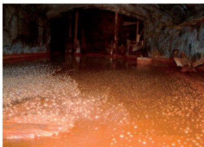
Abb. 5: CO 2 -Austritte im Weidman-Schacht, Abteilung Neuhoftnung, Grube Mercur und Grubenwassereinleitung.
